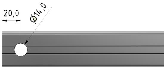
*In das Querprofil wird ein Durchgangsloch zur Aufnahme des Bolzens gebohrt.*
